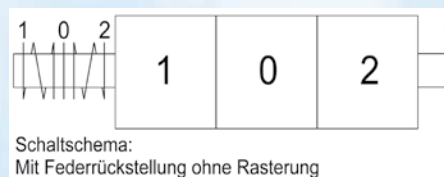
Walvoil SD5/2 Funktion: 1x doppelwirkend 1x doppelwirkend mit Schwimmstellung
