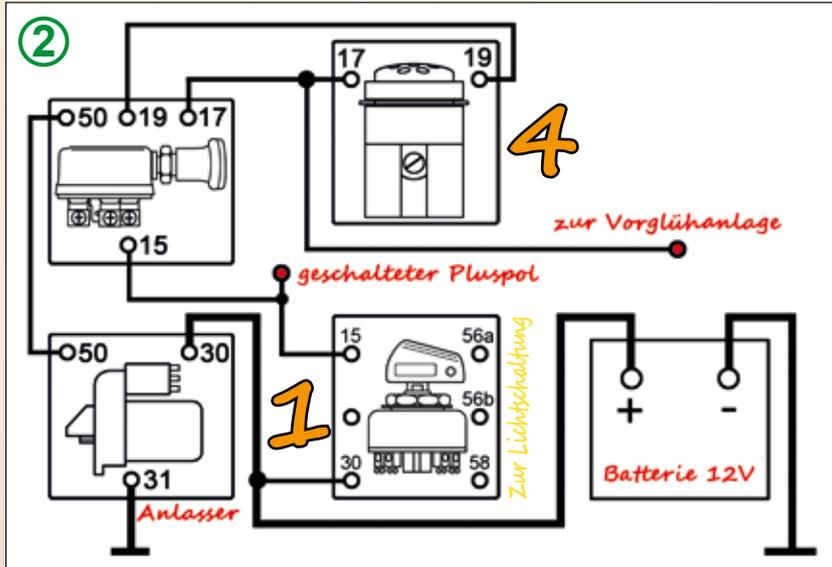
Die Starterschaltung ① für Dieselmotore und die Starterschaltung ③ für Benzinmotore funktioniert mit nur einem aufgezeigten Schlüsselschalter. Mit der Klemmbelegung (15) aller Schlüsselschalter wird die 12Volt-Versorgung für weitere elektrische Fahrzeugkomponenten weitergeleitet. Die Starterschaltung ② besteht aus zwei Schalterkomponenten. Diese bei Oldtimern gängigere Starterschaltung beinhaltet bereits die Fahrlichtschaltung für Abblend- und Fernlicht.
