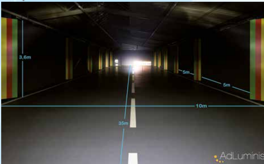
Single Row Lightbar 4600 Lumen - 60 Watt Fernscheinwerfer nach ECE R112
